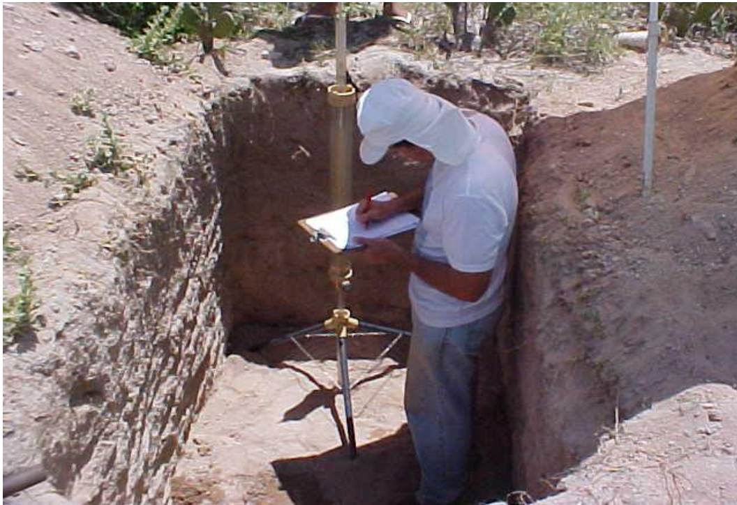
Figura 7 Permeâmetro de Guelph montado no campo (perfil1).
