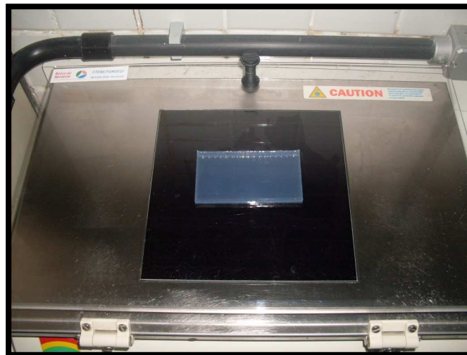
Figura 5. Visualização do gel de agarose a 1,5%, no transluminador.
