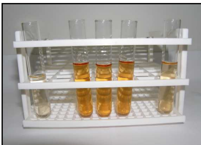
FIGURA 6 – Teor de cloreto, onde se observa o reagente, padrão em triplicata e teste, da esquerda para a direita
