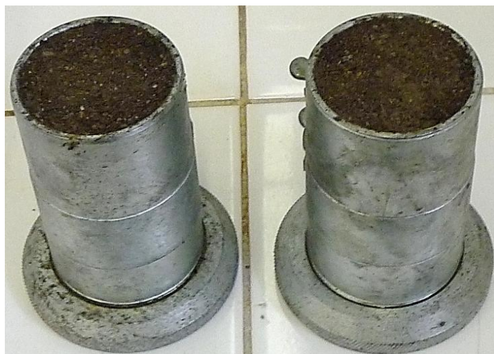
Figura 9. Moldes cilíndricos de aço para confecção dos corpos de prova.
