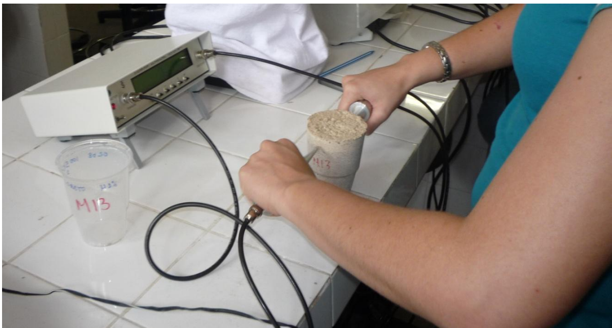
Figura 6. Equipamento Steinkamp BP-7 para ensaios com ultrassom.
