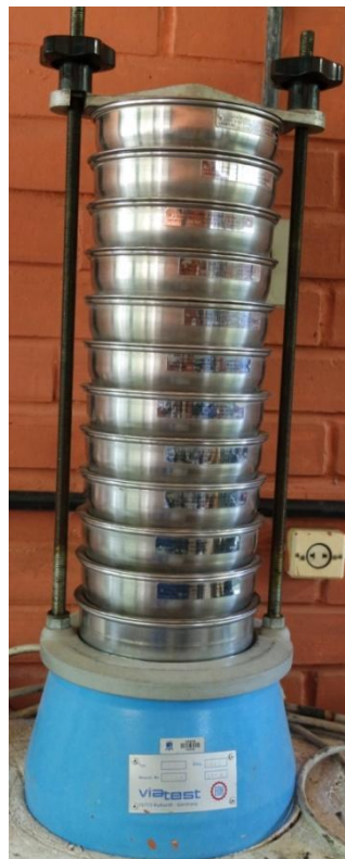
Figura 3. Agitador vibratório Viatest, modelo 76733, com bateria de peneiras.
