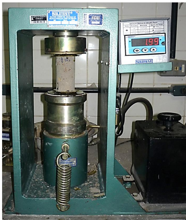
Figura 8. Prensa hidráulica manual Solotest.
