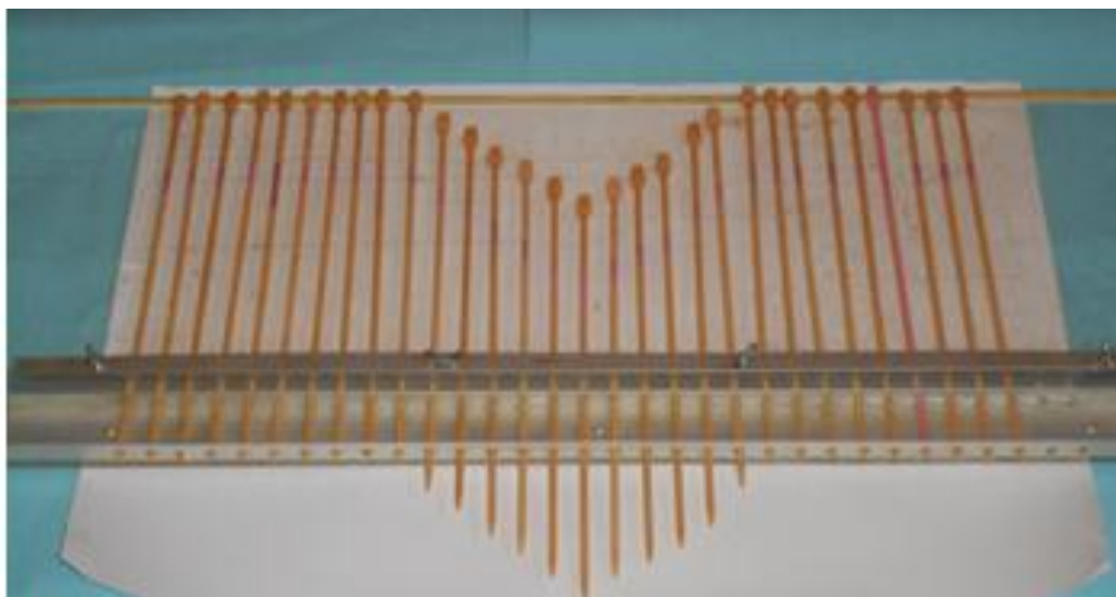
Figura 20. Perfilômetro utilizado para obtenção das seções geométricas dos sulcos de erosão.
