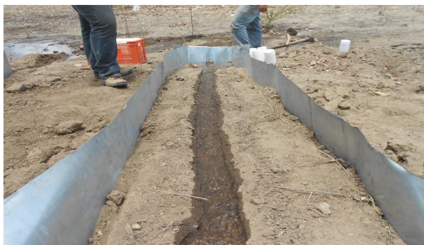
Figura 19. Vista parcial de sulcos pré-formados nos testes de erosão em sulcos na bacia hidrográfica do riacho Exu, Serra Talhada – PE
