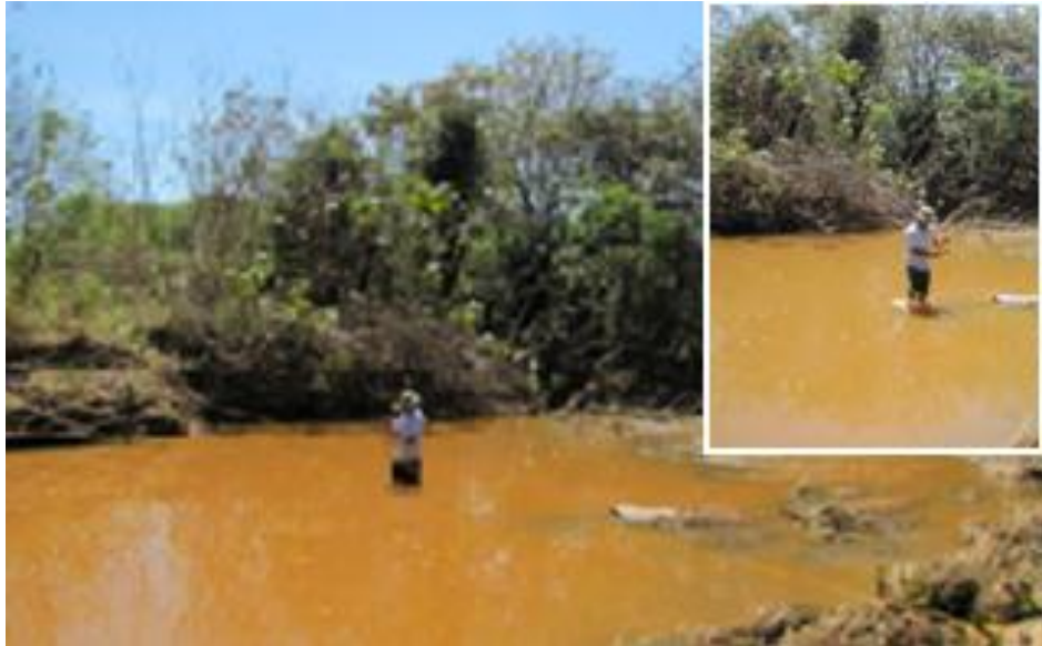
Figura 13. Amostragem de sedimentos suspenso, com o amostrador DH-48 no riacho Exu.
