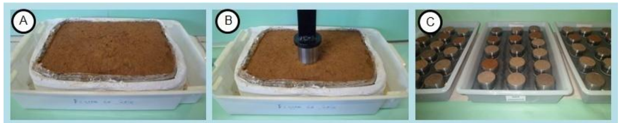
Figura 5. Etapas de obtenção de amostras: (a) condicionamento dos blocos não deformados; (b) coleta de amostras na forma de anéis volumétricos.
