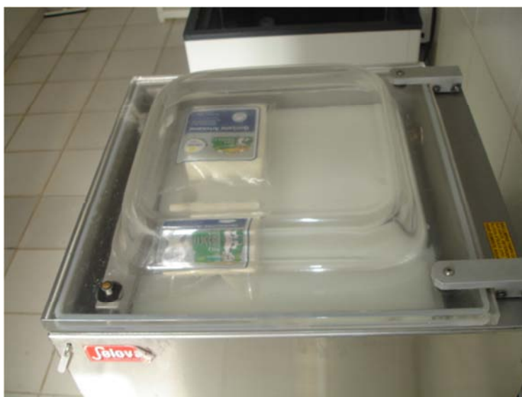
Figura 25. Equipamento para selar embalagem plástica a vácuo.
