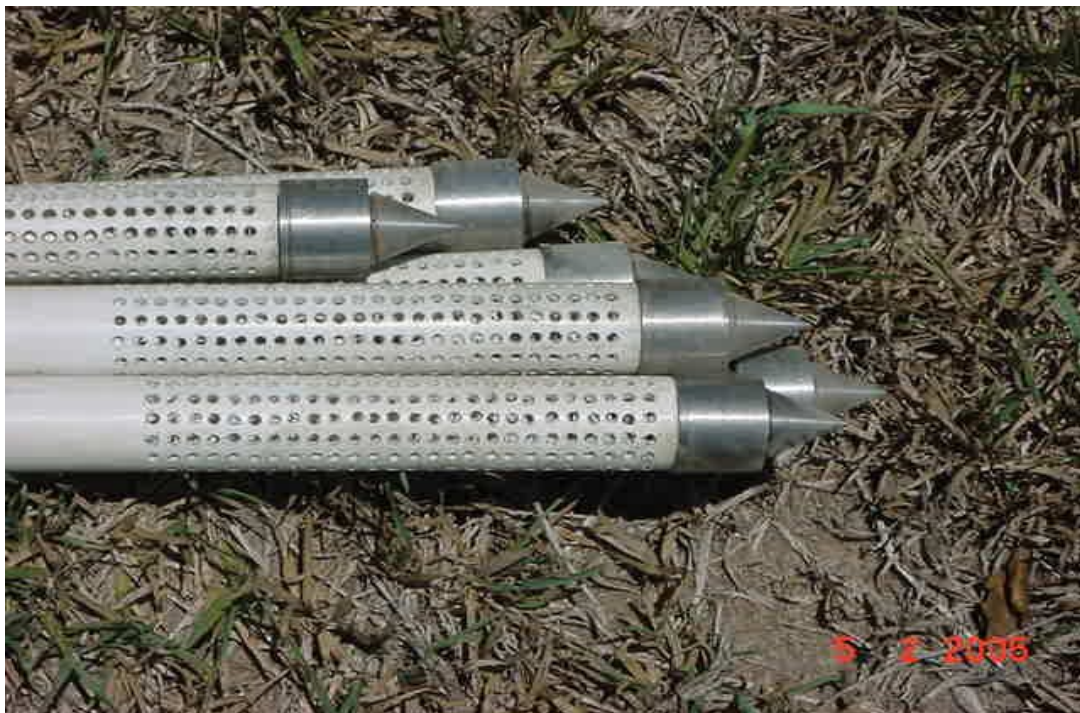
Figura 02 – Piezômetros para testes hidráulicos.
